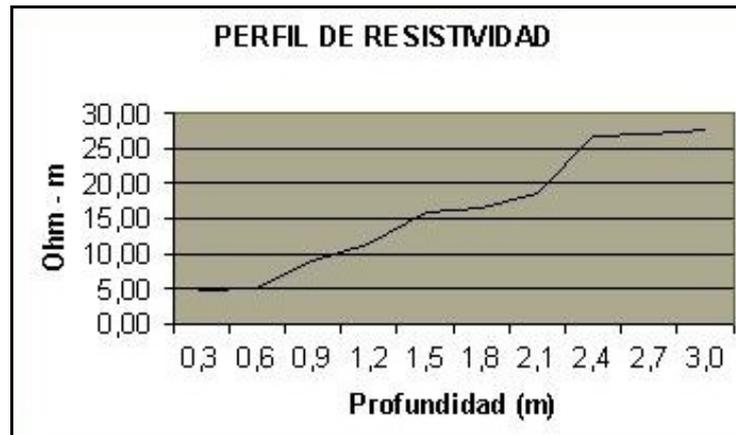
Figura 4.6.- Perfil de resistividad tipo ascendente. [8]
